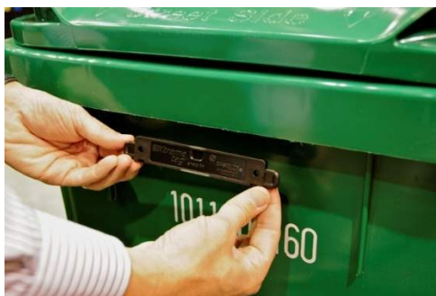
شکل ۳- برچسب الصاقی به سطل ها در موقعیت خاص، قابل پیچ یا چسباندن است
